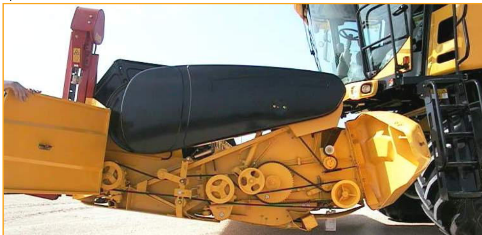
Exemple de montage de la courroie sur M.B New Holland série TX.
